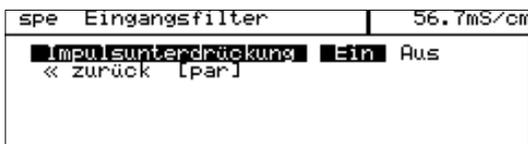
Zur Erhöhung der Störsicherheit der Messungen kann ein Eingangsfilter eingeschaltet werden.
