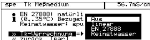
Wenn Sie "Tk-Verrechnung linear" parametriert haben, können Sie anschließend den Tk der Lösung und die Bezugstemperatur eingeben.
