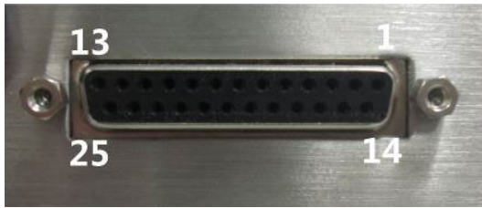
图2- 26: COM2 连接示例
