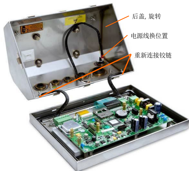
图2- 5: 后盖反转后视图
