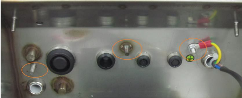
图2- 12: 仪表内部的接地螺柱
