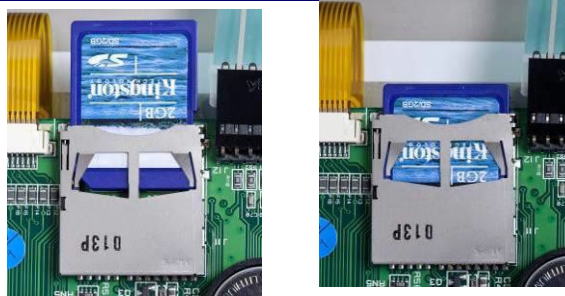
图2- 53: 将SD 卡插入 SD 卡槽 (左); SD 卡安装完成 (右)
