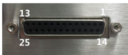
图2- 19: COM1 连接示例
