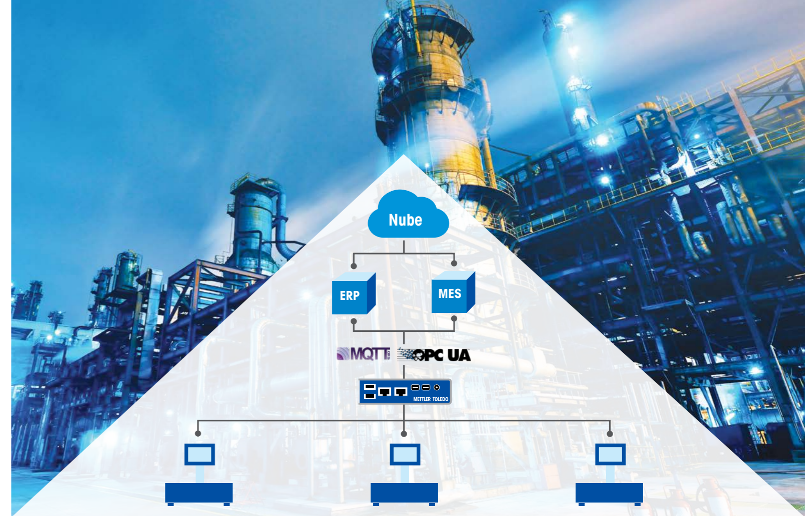
Una sola puerta de enlace de IdCI permite conectar hasta cuatro básculas con sistemas MES, ERP o en la nube.
