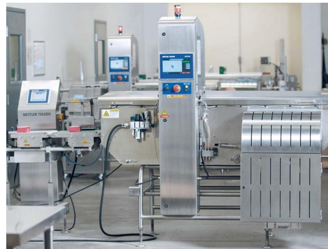
Les systèmes à rayons X X33 vérifient la présence de contaminants dans les emballages en aluminium tandis que les trieuses pondérales XE3 contrôlent les niveaux de remplissage.
