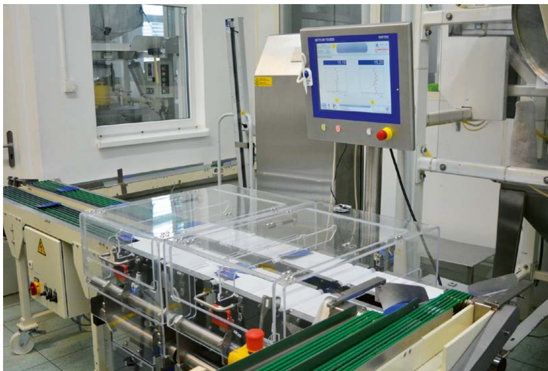
来自梅特勒-托利多的新型双轨 C35 AdvancedLine 自动检重秤提高了 Orthomol 的准确度。
