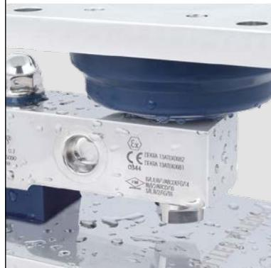
El módulo de pesaje SWB805 MultiMount™ cumple unos estrictos requisitos de diseño higiénico. Aspectos clave como el acero inoxidable pulido como un espejo, las superficies autodrenantes y la célula de carga totalmente sellada facilitan la limpieza rápida y exhaustiva de estos módulos de pesaje.
