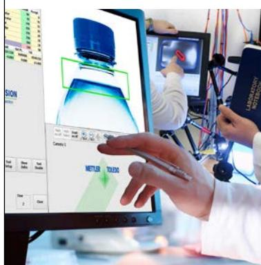
La inspección por visión comprueba la formación de los cuellos de las botellas y las roscas de los tapones para garantizar su integridad y evitar el riesgo de fugas del producto.
