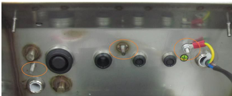
图2-10: 仪表内部的接地螺柱
