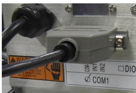
图2-68: 使用COM1/2 连接PQ50-3100 打印机
