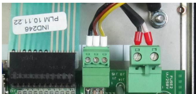
图2-60: 使用COM1 连接PQ50-3100 打印机
