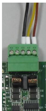
图2-57: 使用COM2 连接PQ50-2100 打印机
