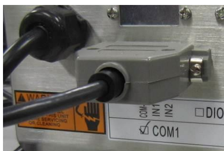
图2-65: 使用COM1/2 连接PQ50-2100 打印机
