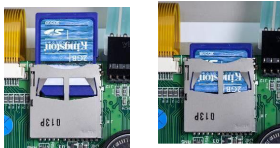
图2-49: 将SD 卡插入 SD 卡槽 (左); SD 卡安装完成 (右)
