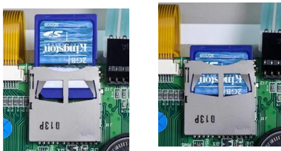
图 2- 67: 将 SD 卡插入 SD 卡槽 (左); SD 卡安装完成 (右)
