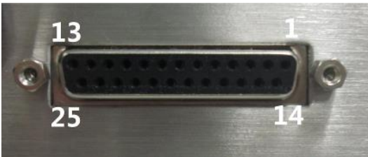
图 2- 44: COM2 连接示例
