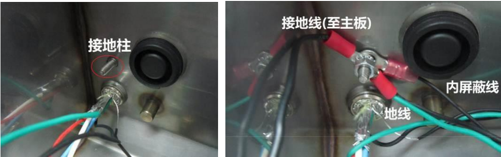
图 2- 31: 仪表内部接地柱接线(接线前(左),接线后(右))
