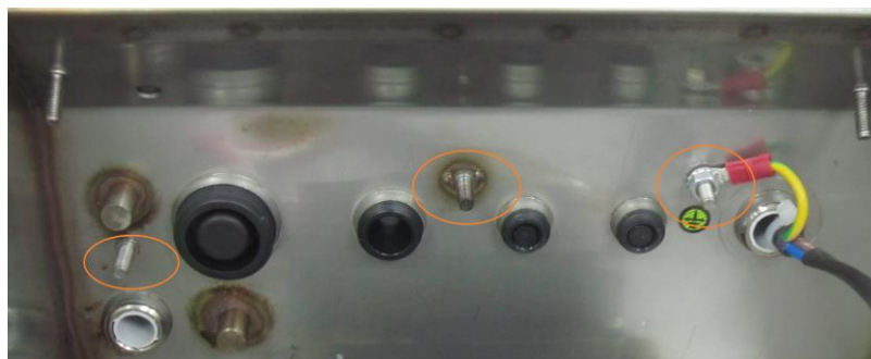
图 2- 13: 仪表内部的接地螺柱
