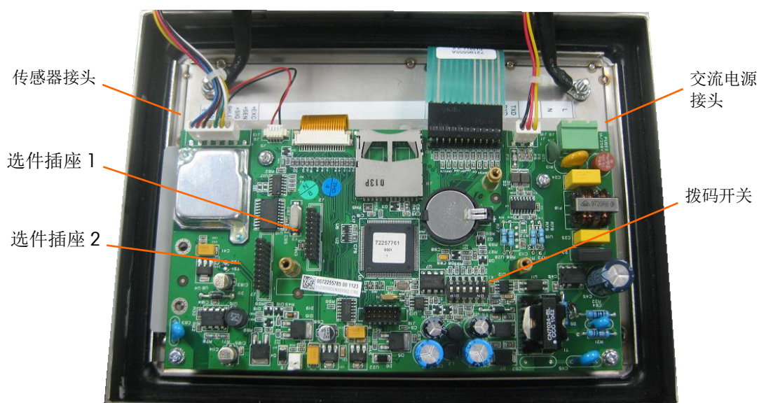
图 2-17: 普通型 IND245 主板接线
