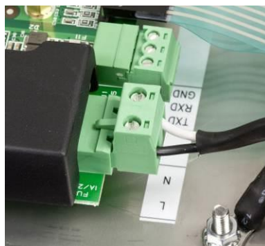
图 2-6: 模拟式仪表交流电缆接线
