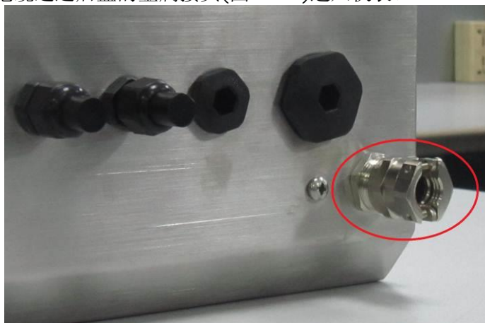
图 2-24: 仪表后盖的数字传感器接头
