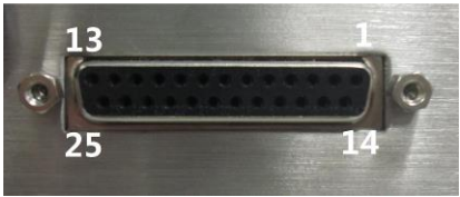
图 2- 34: 普通型模拟式仪表 COM1 连接示例
