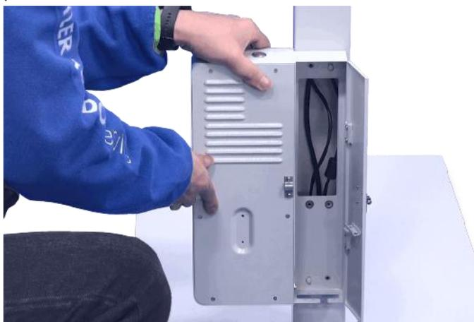
3. Fije el módulo electrónico con cuatro tornillos de cabeza troncocónica M4. Herramienta: destornillador Phillips.
