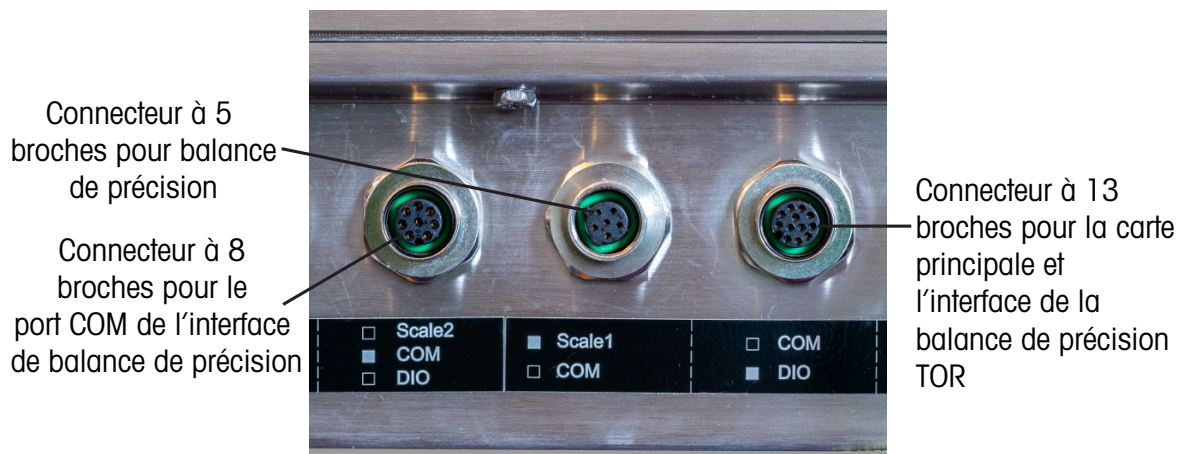
Fig. 47: Connecteurs M12 externes associés à la carte d'interface de précision
