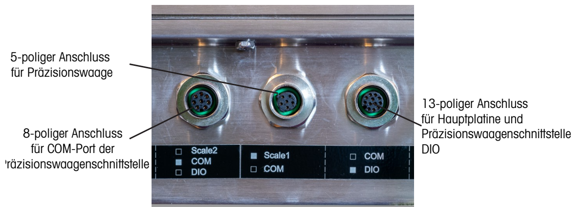
Abb. 47: Mit der Präzisionsschnittstellenplatine verbundene externe M12-Steckverbinder
