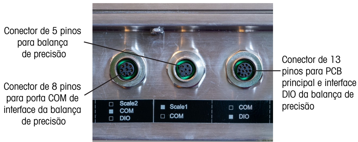
Figura 47: Conectores M12 Externos Associados à Placa de Interface de Precisão
