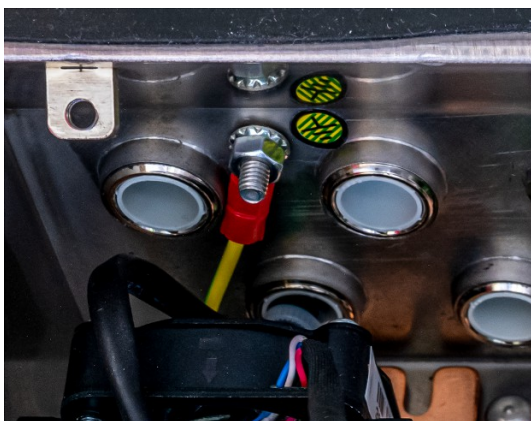
Figura 35: Bullone di messa a terra nell'alloggiamento per ambienti difficili
