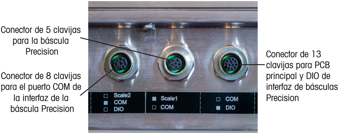
Fig. 47: Conectores M12 externos asociados con la tarjeta de interfaz Precision
