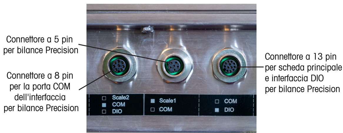
Figura 47: Connettori M12 esterni associati alla scheda di interfaccia Precision
