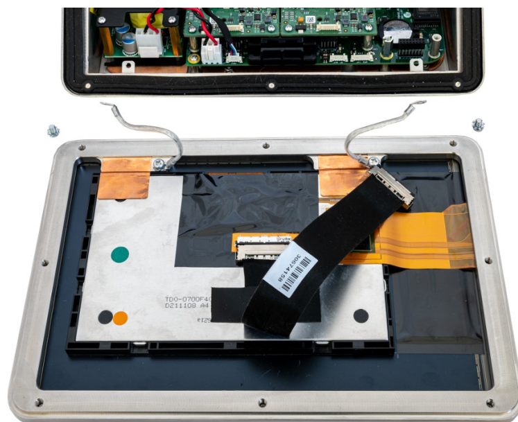
Figura 28: Coperchio anteriore staccato dall'alloggiamento
