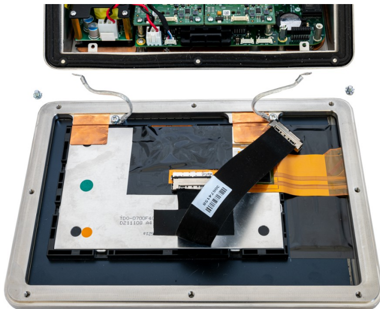
Fig. 28: Cubierta delantera desmontada de la carcasa
