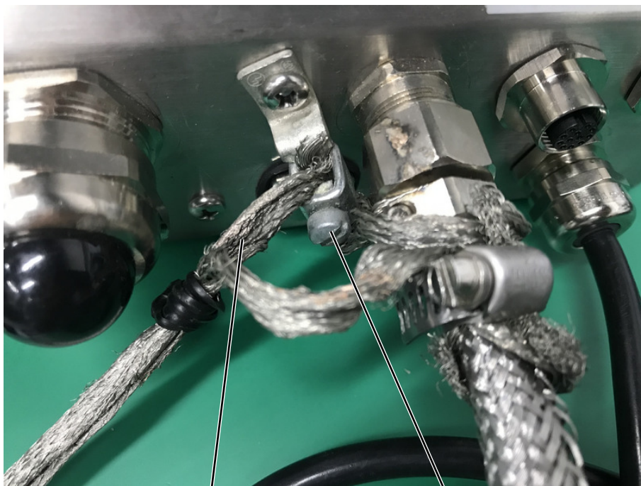
Conduttore di drenaggio esterno
