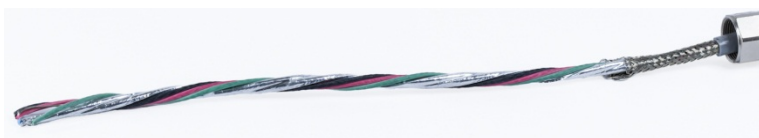
Figura A-58: Guaina interna accorciata
