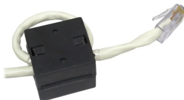
Figura A-20: Installazione del blocco di ferrite
