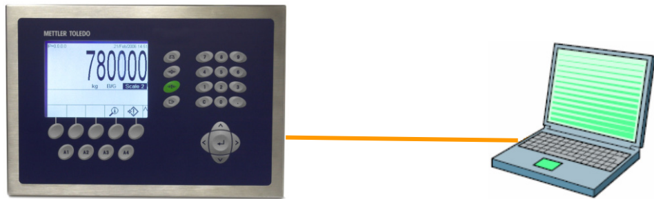
Figura D-1: Connessione del terminale IND780 a un PC tramite cavo incrociato
