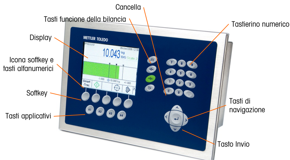
Figura 2-2: Componenti del pannello frontale e posizione dei tasti
