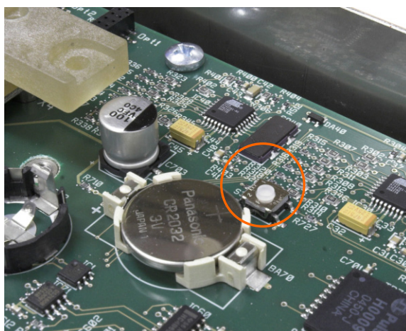
Figura A-38: Posizione del pulsante di reimpostazione generale sulla scheda madre
