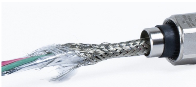
Figura A-59: Guaina interna sfilacciata
