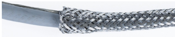
Figura A-55: Guaina esterna spinta sopra l'estremità coperta dal nastro.
