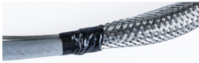
Figure A-54 : Gaine externe fixe avec du ruban isolant
