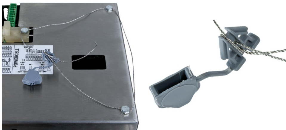
Figure A-117: Le fil de plombage étant installé, enfiler le fil à travers le plombage
