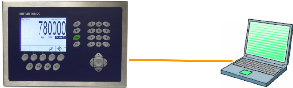
Figure D-1 : Connexion de l'IND780 à un ordinateur avec un câble simulateur
