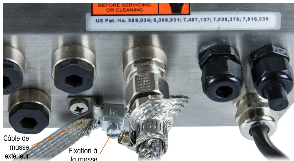
Figure A-65 : Câble et tresse installés dans une enceinte pour environnement difficile
