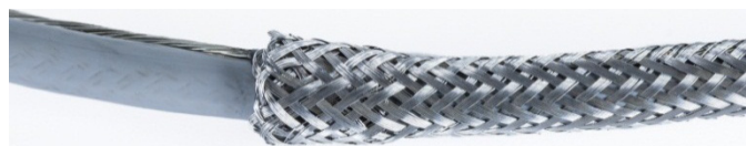
Figure A-55 : Gaine externe repoussée par-dessus le ruban isolant
