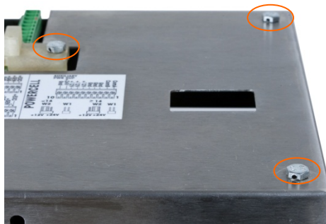
Figure A-116: Couvercle du panneau arrière de l'enceinte avec les vis de plombage installées
