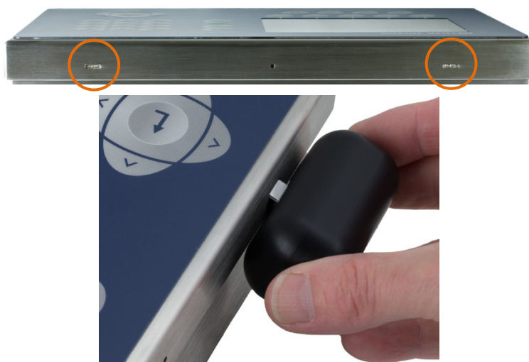
Figure A-2: Ouverture de l'enceinte pour environnement difficile, méthode préférée
