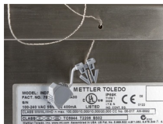
Figure A-121: Fil de plombage enfilé à travers le couvercle et l'attache
