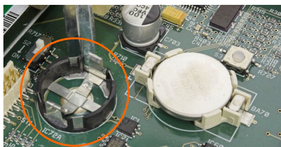
Figura 1-2: Conector de código de seguridad de hardware IND780 en la tarjeta madre
