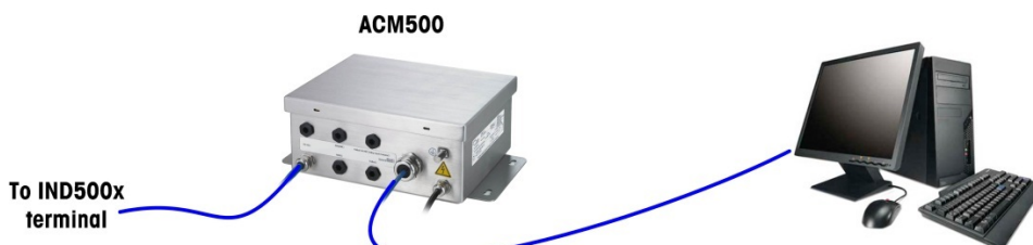
Abb. 130: Verbindung mit Crossover-Kabel
