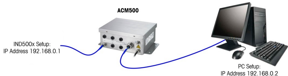
Abb. 132: Beispiel: IP-Adresskonfiguration (Crossover- oder Hub-Konfiguration)
