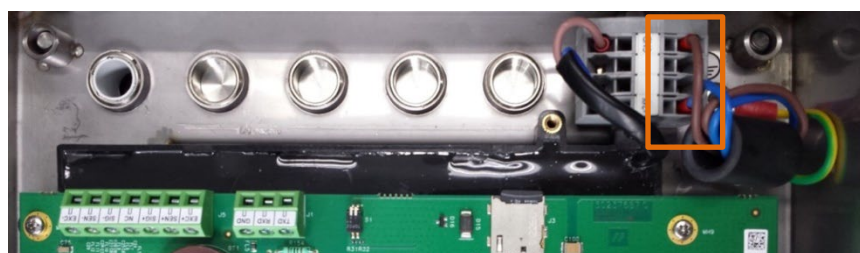
Figura 2-6: Conexiones de entrada de energía de CD, vista interna
