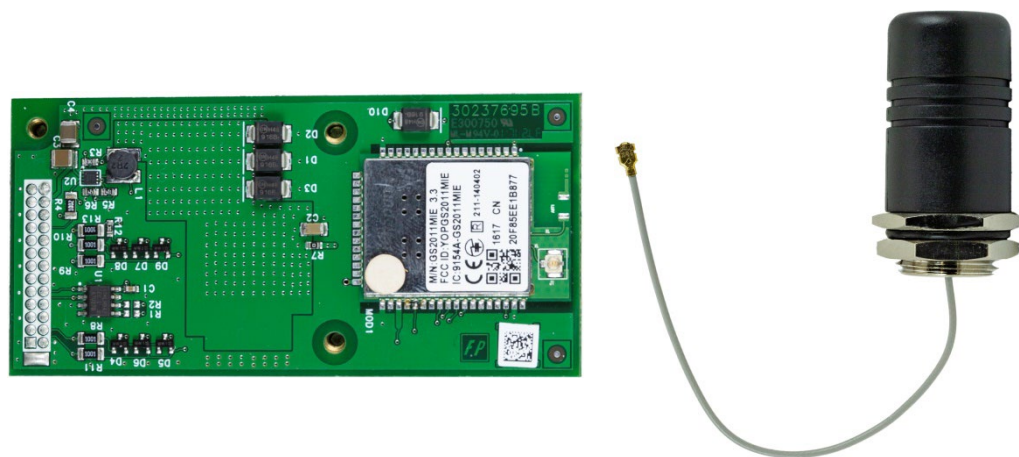
Figura 2-16: Antenna e scheda opzionale WiFi IND256x
