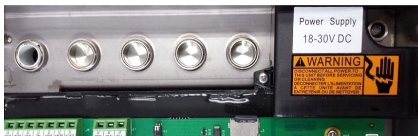
Figura 2-5: Conector de Entrada de Energia CC com Tampa
