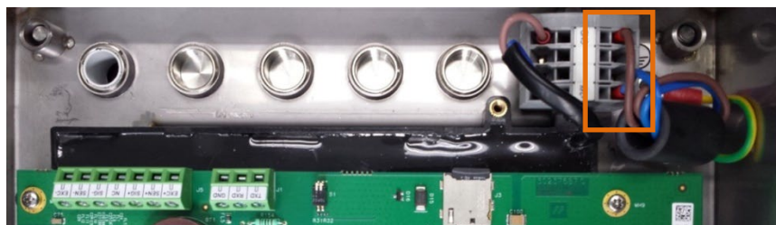
Figura 2-6: Conexões de Entrada de Energia CC, Vista Interna
