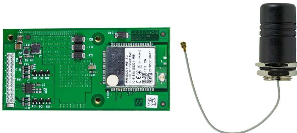
Figura 2-16: Tarjeta opcional WiFi del IND256x y antena
