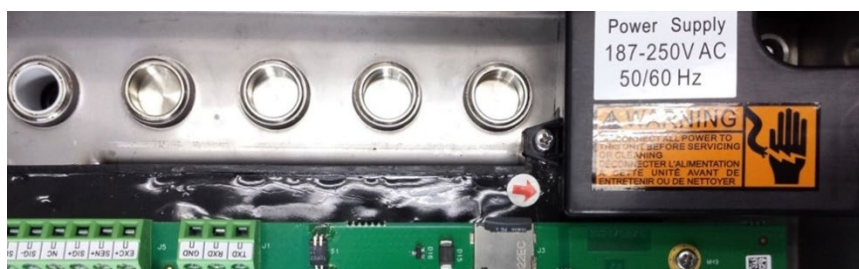
Figura 2-3: Conector de entrada de energía de CA con cubierta
