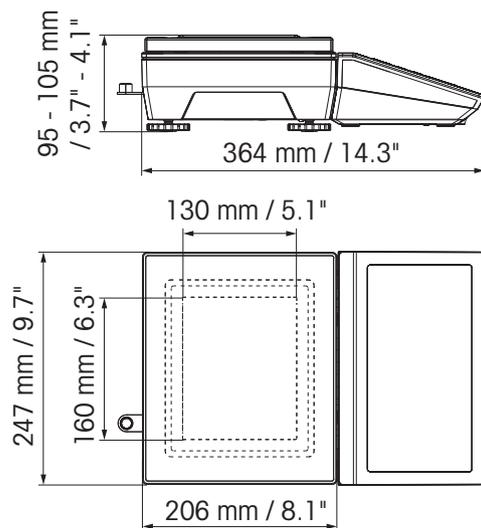
**ICS4\_5 Kompaktwaage mit XS-Wägebrücke und Windschutz**
