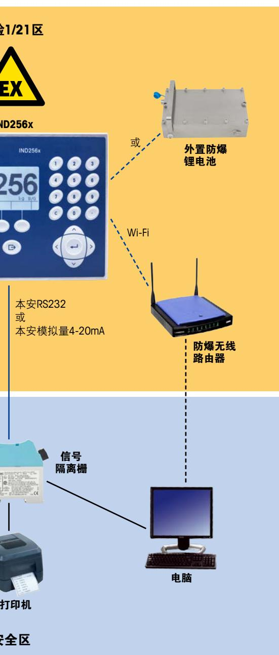
IND256x防爆称重仪表可以配置Wi-Fi通信模块进行数据采集，使生产管理具有可追溯性。同时无线通信可以克服在防爆场合布线的局限性，减少现场改造的成本。
