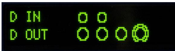
Figure 4-5 : Écran de test E/S discrètes
