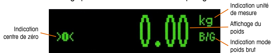
Figure 2-1 : Affichage en mode de pesage
