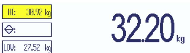
I limiti di tolleranza e il peso target sono visualizzati su 3 righe.
