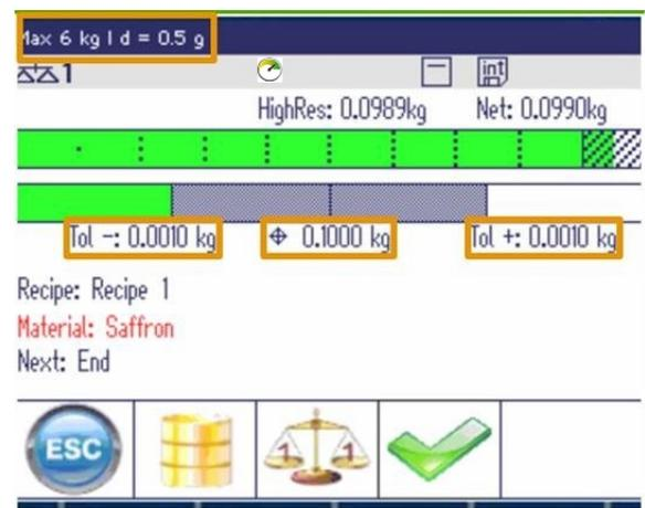
Grazie all'applicazione SpeedWeigh, l'operatore può velocizzare la pesata di materiali voluminosi lavorando con una precisione di indicazione maggiore, ovvero una risoluzione minore, e pesare soltanto materiali fini e di valore con una precisione di indicazione minore, ovvero risoluzione maggiore
