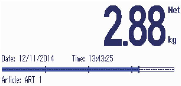
Der Balken zeigt ungefähr an, welcher Anteil der Waagenkapazität bereits belegt ist und welche Kapazität noch zur Verfügung steht.
