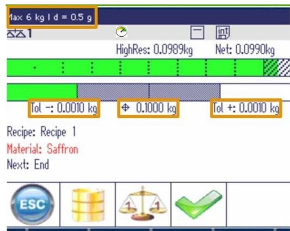
Dank der SpeedWeigh-Applikation können Sie das Wiegen von Schüttgütern beschleunigen, indem Sie mit einer höheren Ablesbarkeit, d. h. geringerer Auflösung, arbeiten und nur feine und wertvolle Materialien mit einer geringeren Ablesbarkeit, d. h. höherer Auflösung, wiegen.
