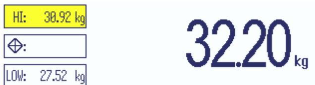
Toleranzen und Zielgewicht werden in 3 Zeilen angezeigt. Im Beispiel wird die Standardfarbe für Wägegut angezeigt, das über der oberen Toleranzgrenze liegt.
