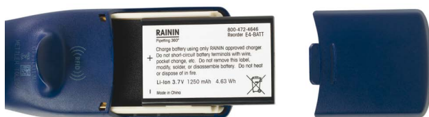
Figura 26: Cambio de la batería
