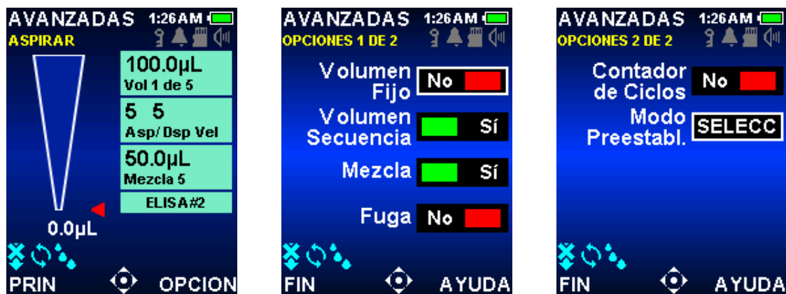
Figura 13: Opciones del Modo avanzado: tecla de función OPCION en la pantalla operativa (izquierda), Opciones 1 de 2 (centro) y Opciones 2 de 2 (derecha)
