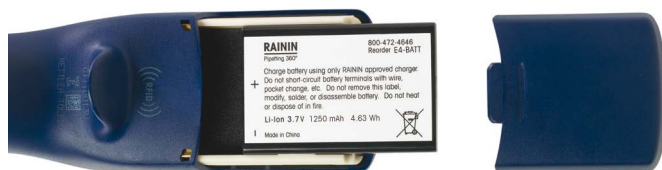
Figura 4: Instalación de la batería principal
