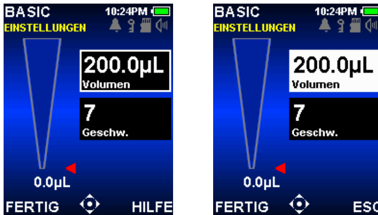
Abbildung 8: Basic-Modus: mit markiertem Feld Geschwindigkeit (links) und Geschwindigkeit im Bearbeitungsmodus (rechts)
