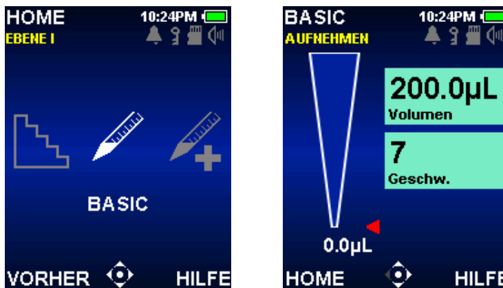
Abbildung 7: Basic-Modus in Menüebene I markiert (links), Bedienungsanzeige des Basic-Modus (rechts)
