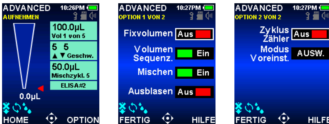
Abbildung 14: Optionen im Advanced-Modus: OPTION -Softkey in der Bedienungsanzeige (links), Option 1 von 2 (mittig) und Option 2 von 2 (rechts)
