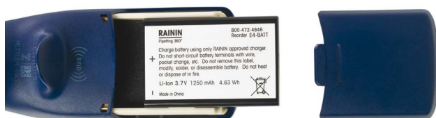
Abbildung 27: Austausch des Akkus
