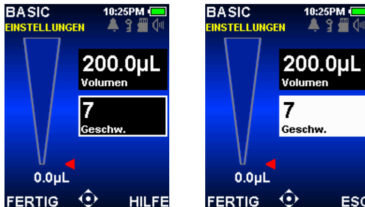
Abbildung 9: Basic-Modus mit markiertem Feld Geschwindigkeit (links) und Geschwindigkeit im Bearbeitungsmodus (rechts)
