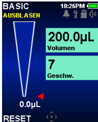
Abbildung 12: Ausblasvorgang im Basic-Modus
