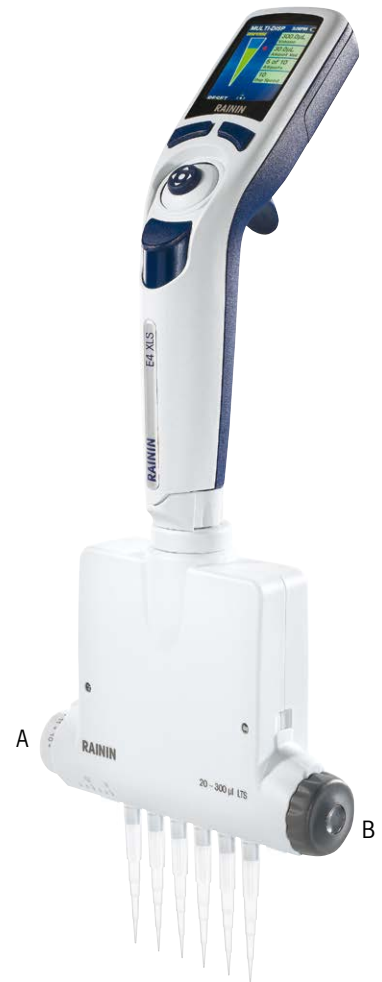
Abbildung 36: E4 XLS-Adjustable Spacer-Pipette A: ABSTANDSEINSTELLUNG B: BEGRENZER
