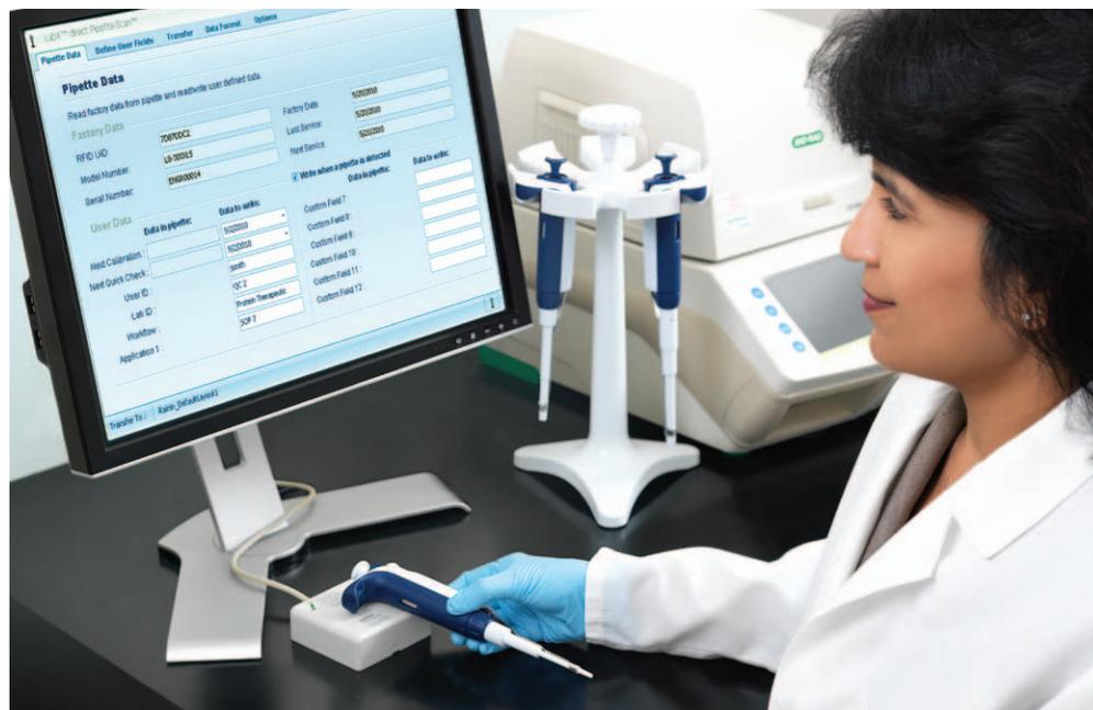
**La tecnologia RFID sta rivoluzionando il modo in cui i laboratori tracciano i dispositivi e Rainin è il primo produttore di pipette a offrire una soluzione completa per la gestione delle pipette: pipette con chip RFID integrato, scanner RFID e relativo software di gestione.**
