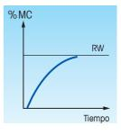
Ajuste la temperatura hasta alcanzar el valor de referencia (corrección).
