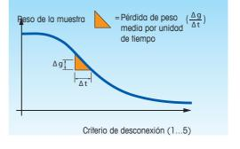
La selección del criterio de desconexión influye en la duración y exactitud de la medición. El tiempo de secado más corto se da con la selección de AK 1, aunque a menudo el secado no es completo y se reduce la repetibilidad. Mediante la selección del criterio de desconexión se optimiza la brevedad de la medición en relación con la exactitud exigida al resultado de medición.
