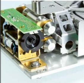
La tecnología HiRes (HRT) de METTLER TOLEDO incluye dos pesas incorporadas. En combinación con la tecnología de calibración totalmente automática (FACT), esta tecnología permite que la balanza realice las tareas de ajuste y linealización de forma automática.
