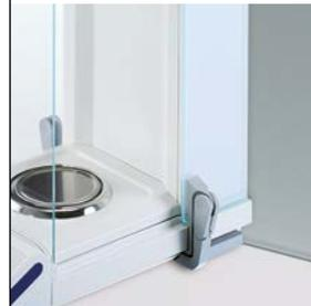
Dank der zweiteiligen, nicht hervorstehenden Windschutztüren und der seitlich an der Waagenrückseite installierten Anschlüsse sparen Sie wertvollen Platz.
