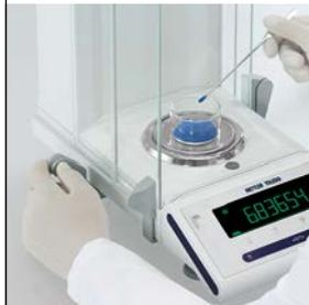
So verringern Sie die Anzahl der Bewegungen für jeden Wägevorgang: Öffnen Sie die ErgoDoor Windschutztür mit einer Hand, während Sie gleichzeitig mit der anderen Hand die Probe platzieren.
