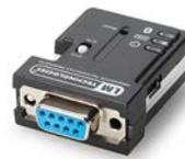
天平和 PC、平板电脑或打印机之间无线发送数据。无需其他软件。
