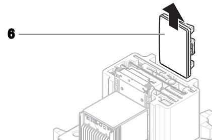
5 小心取出带有防风罩门和显示屏支架（7）的包装套件。
