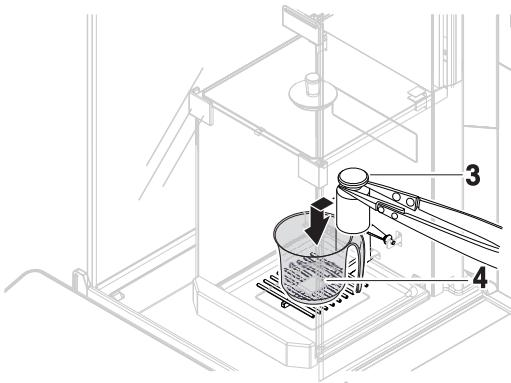
10 移除测试砝码，并将容器留在秤盘上。
