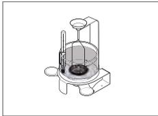
Dichte-Kit ME-DNY-43 für Waagen mit einer Ablesbarkeit von 0,1 mg
