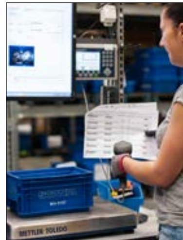
Inställning av våg för artikelpackning med terminalscanner från packlista
