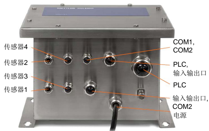
图 2-31 IND131 接线盒式的接线位置
