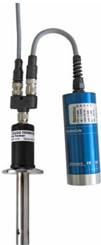
El calibrador UniCond se conecta al sensor UniCond del proceso
