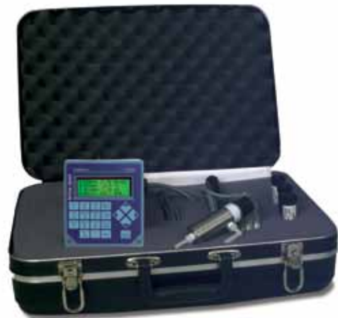
1885 Kalibrierkit von Thornton kann zur Kalibrierung der Zellkonstanten des Sensors verwendet werden.
