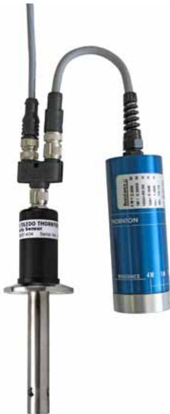
UniCond Calibrator ist am UniCond Sensor angeschlossen, der im Prozess misst.
