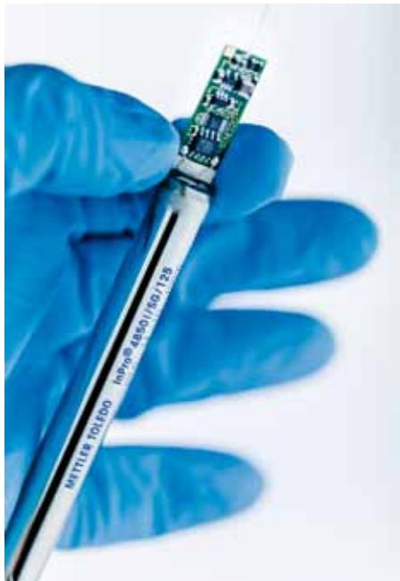
重要的 ISM 诊断工具是**动态寿命指示器 (DLI)**。DLI 可以向操作人员与仪器工程师明确指示当前过程条件对传感器性能的影响程度。对于 pH 传感器，通过持续分析过程条件和其他因素，DLI 可以计算出传感器的剩余可靠使用寿命。如果过程条件的恶劣程度发生变化，则 DLI 会快速做出适当反应。此外，DLI 可根据过程条件进行调整，以确保诊断数据始终可靠。
