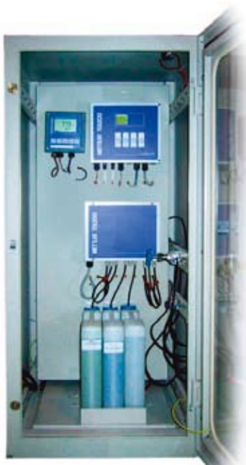
金川集团的自动化清洗和校准系统
