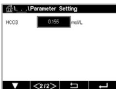
파라미터 **HCO<sub>3</sub>**는 트랜스미터에 연결된 센서의 CO<sub>2</sub> 전해질 내에 있는 탄산 수소염의 농도를 설명합니다. 이것도 센서별 파라미터입니다. 기본값 0.050 Mol/L은 InPro 5000i에 유효합니다. InPro 5000i를 사용할 경우 이 파라미터를 변경하지 마십시오.
