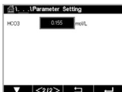
O parâmetro **HCO<sub>3</sub>** descreve a concentração de carbonato de hidrogênio no eletrólito de CO<sub>2</sub> do sensor conectado ao transmissor. sendo, também, um parâmetro específico do sensor. O valor padrão 0,050 Mol/L é válido para o InPro 5000i. Não altere esse parâmetro se o InPro 5000i for utilizado.
