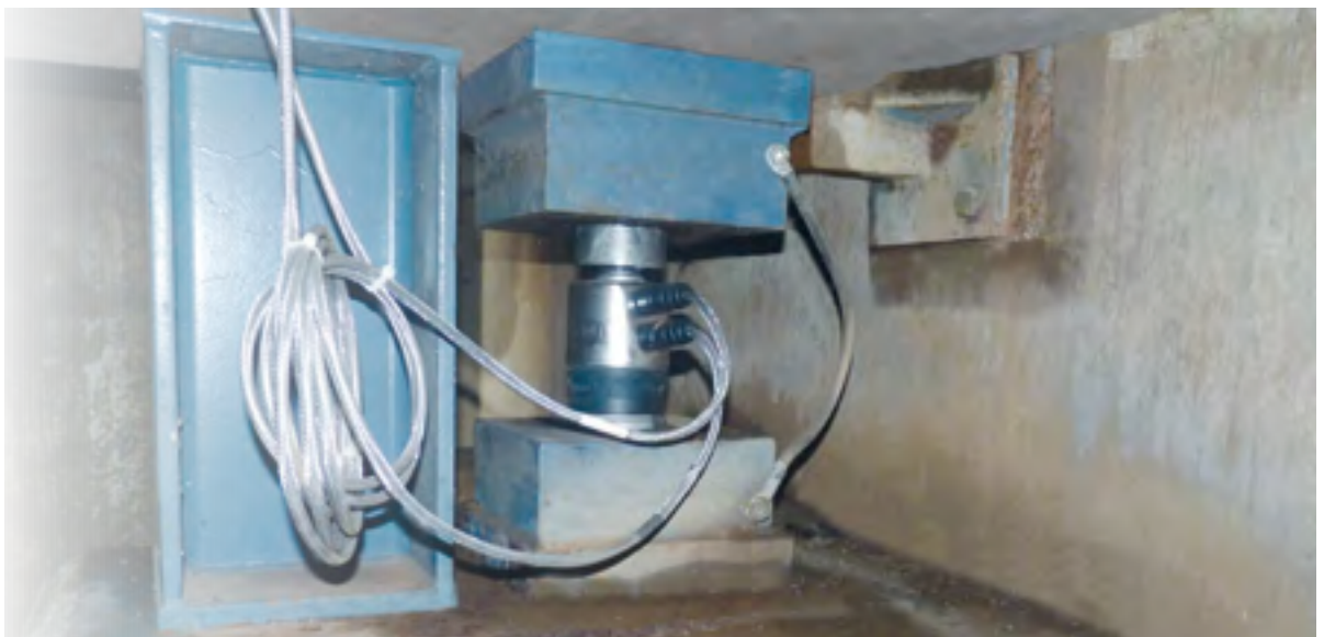
Neu installierte PDX® Wägezelle.
