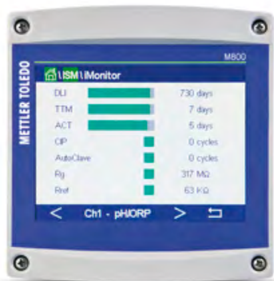
Ein M800-Transmitter mit dem iMonitor-Diagnoseprogramm für Sensoren.
