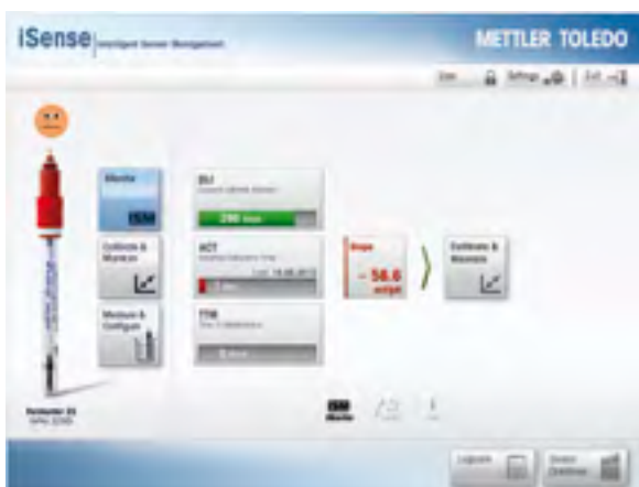
Der Smiley liefert auf einen Blick Informationen zum Sensorzustand. Unter der Funktion «Diagnose» erfahren Sie, ob dieser Sensor kalibriert werden muss.
