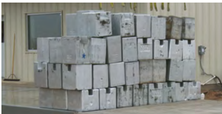
Der Austausch herkömmlicher Wägezellen, Kabel oder Anschlusskästen erfordert eine aufwändige Neukalibrierung mit schweren Prüfgewichten.
