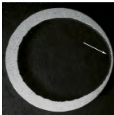
Korrosionsschaden in Kesselspeisewasserleitung durch FAC (Flow-accelerated corrosion)
