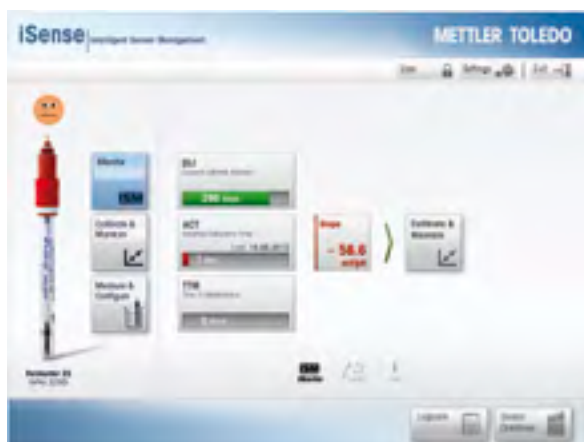
Der Smiley liefert auf einen Blick Informationen zum Sensorzustand. Unter der Funktion «Diagnose» erfahren Sie, ob dieser Sensor kalibriert werden muss.
