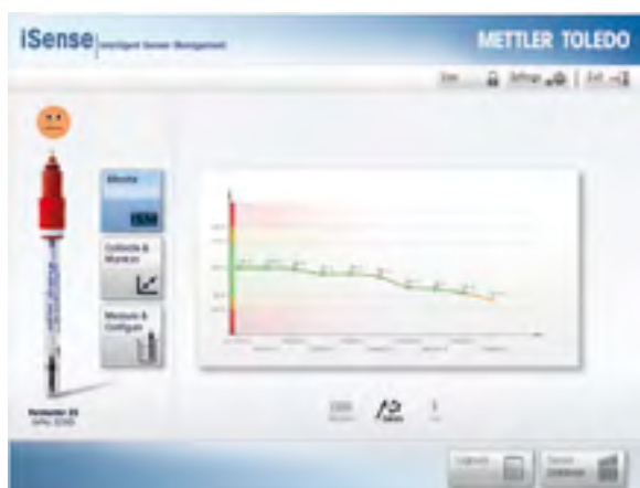
Die Funktion Sensorverlauf zeigt, wie der Sensor im Anlagenprozess über einen bestimmten Zeitraum beeinträchtigt wurde und unterstützt geplante Wartungsarbeiten.
