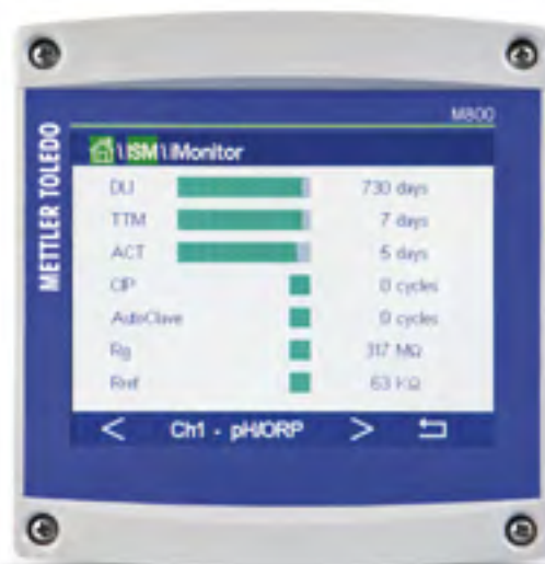
Ein M800-Transmitter mit dem iMonitor-Diagnoseprogramm für Sensoren.
