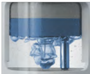
Action de nettoyage du système EasyClean 100. La formation de bulles, centrée sous la sonde garantit un nettoyage doux.
