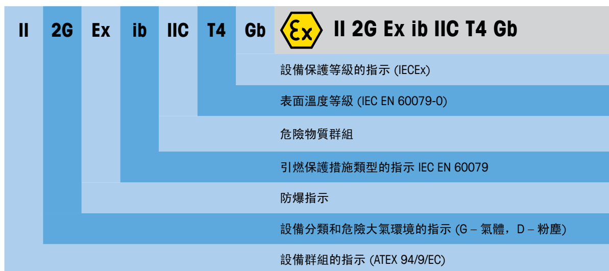
圖 5 根據 ATEX 94/9/EC 進行的典型電氣設備標記
