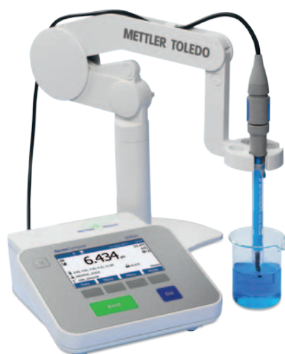
圖3：通用 pH 計配有自定義的超大彩色顯示螢幕。梅特勒-托利多SevenCompact S220 pH 計，配有 uPlace™ 電極支架
