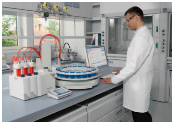
圖2：進行全自動分析和數據管理的滴定解決方案。梅特勒-托利多卓越系列 T90，和 Rondo 20 自動進樣器
