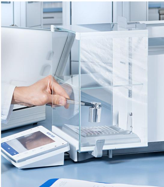
對所有的測量件而言，都是經由一個特定件定義出標準，而在稱重設備的領域中，這標準來自於測試法碼的文件中。測試法碼的值 (來自於校正報告) 和將其放置於稱重設備端螢幕所顯示的讀值，這驗證值 (校正報告中的值) 與器示值所存在的關係，就是這台設備的運作模式。舉例來說，當放置一個 5 kg 的測試法碼於稱重設備上時，其螢幕的顯示值為 6 kg 時，及建立了一個已知值與待測值的關係，所以，您可以合理的認為，當放置一個已知的 10 kg 法碼於稱重設備端，螢幕將顯示 12 kg。這件簡單但極其重要的例子，就是校正的基礎—藉由已知和待測件間的關係，定義設備的運作模式。
