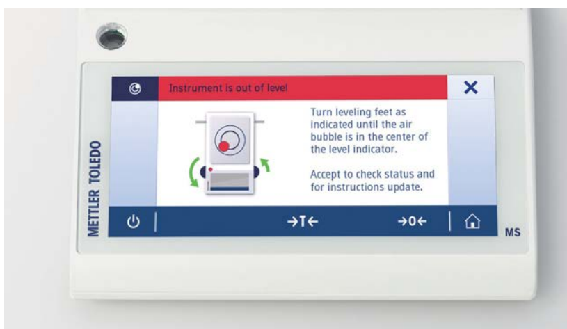
內置 LevelControl 將在天平非水準時發出警告。螢幕上的指南可說明操作員在數秒內水平調整天平。
