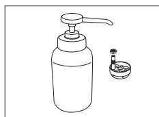
冲洗设施，带有滴定头插件和塞子
