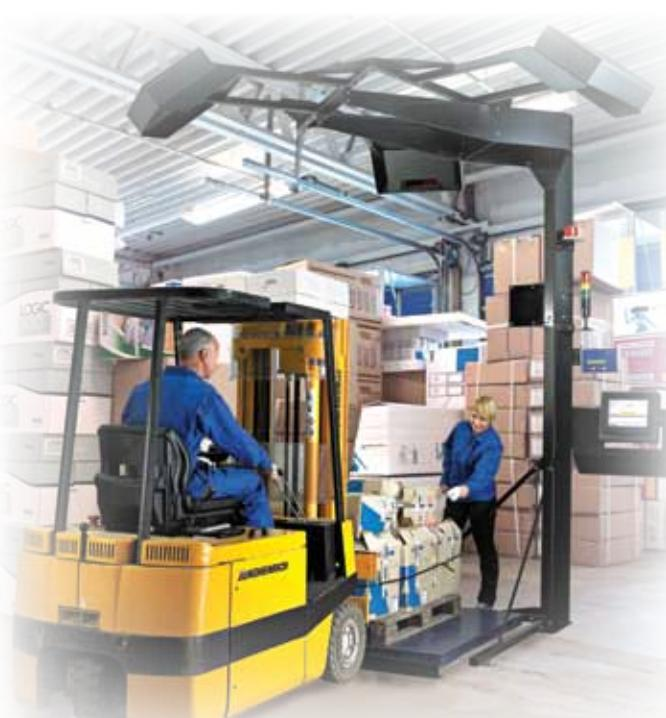
Puesto que el CSN840 es capaz de interactuar con cualquier sistema existente, el sistema informático de Southeastern puede actualizar automáticamente las facturas de cargas con los pies cúbicos del envío total, y crear un certificado de pesaje e inspección para documentar la longitud, la anchura, la altura y los pies cúbicos de cada pieza medida en la expedición. El proceso completo, desde la medición hasta la documentación, tarda menos de 10 segundos en completarse.
